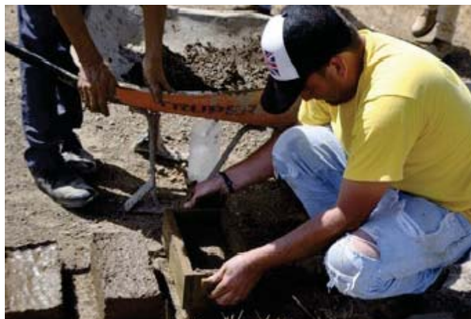
Figura 3. Fotografía elaboración de ladrillos de adobe.
