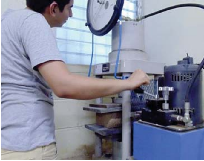
Figura 4. Fotografía de ensayo a compresión del ladrillo de adobe
